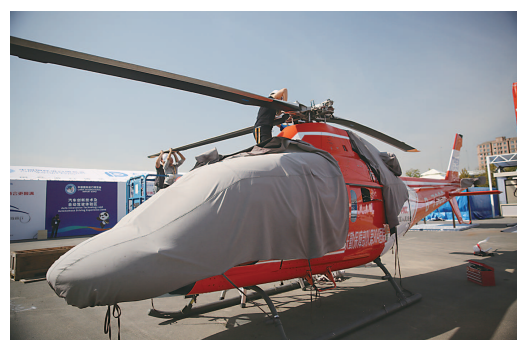
工作人员正在对一架参展的救援直升飞机安装螺旋桨
