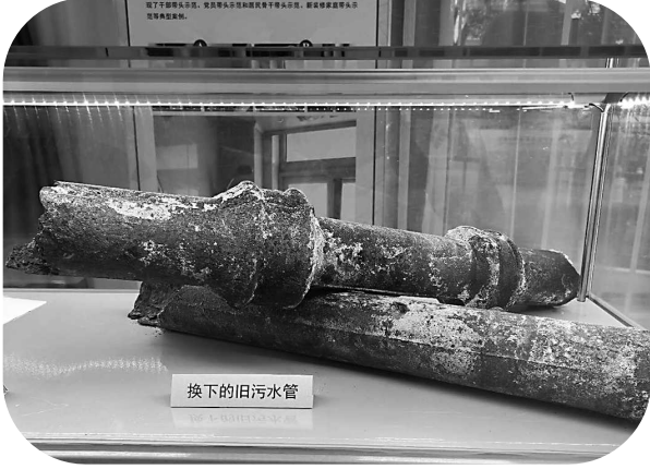
新泾六村被换下的污水管
