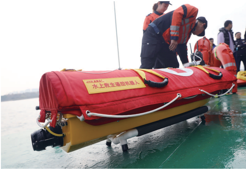
水上救生遥控机器人采用新型喷水推进
