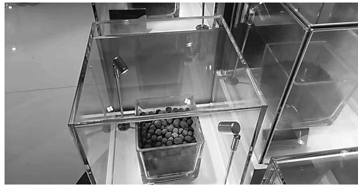
可直接入炉使用的铁矿石球团矿,使钢铁生产过程排放更低
