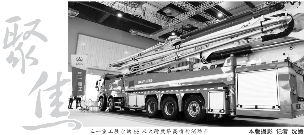
三一重工展台的 65 米大跨度举高喷射消防车
