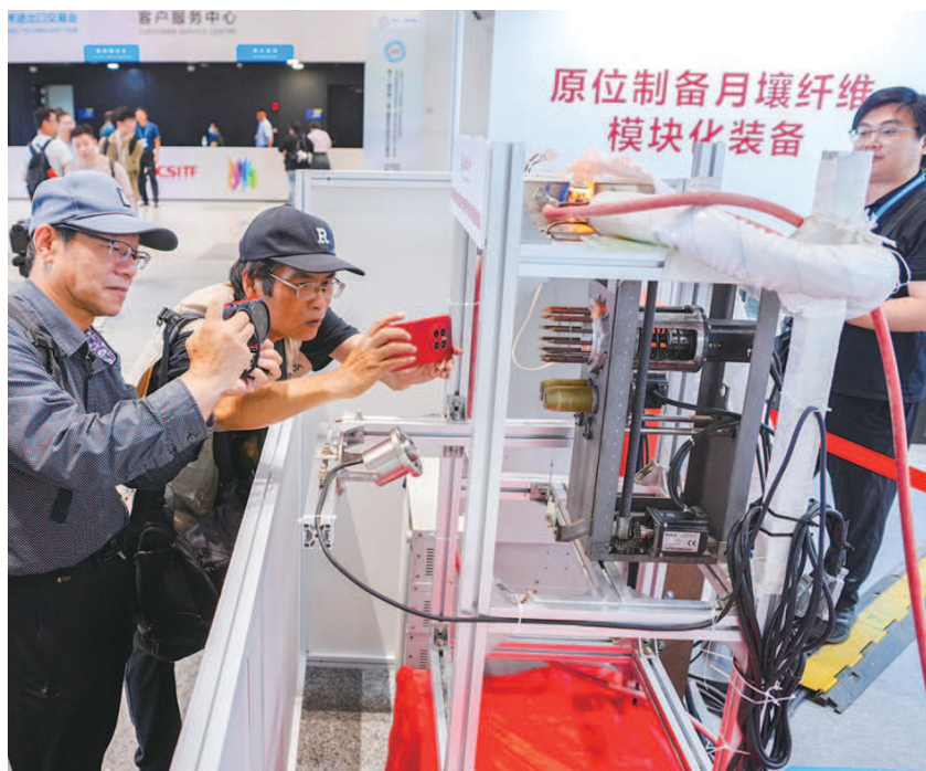
东华大学先进纤维材料全国重点实验室自主研发的“月壤原位制备玄武岩纤维模块化装备”展出，月壤原位制备玄武岩纤维用于中国月球基地建设
